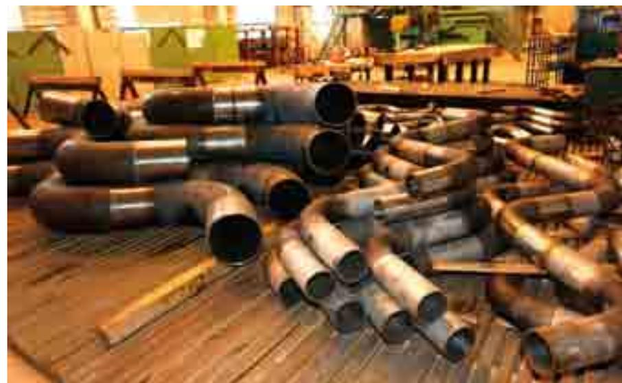
диаметром 426 миллиметров и толщиной стенки 42 миллиметра. При этом стенка в растянутой зоне (по внешнему диаметру) утончилась всего до 35 мм, тогда как по ГОСТу можно — до 27 мм. То же и с параметром овальности: на ЦПЗ уложились в 0,5 процента, а самые жесткие требования допускают отклонение аж в 6 процентов.
