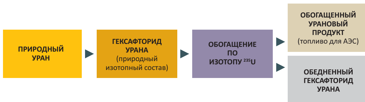
Рис. 3. Технологическая схема конверсии природного урана
